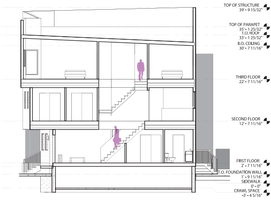
UNIT 4 - LONGITUDINAL SECTION
