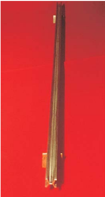
Figure 1.1 The standard platinum–iridium meter bar. (Courtesy Bureau International des Poids et Mesures, France)
